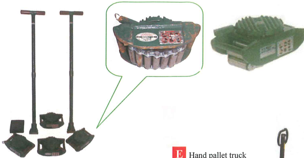
A Machinery rollers, 15 ton
